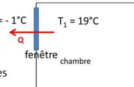
$|T_1 - T_2|$ : écart de température entre les 2 faces de la paroi étudiée. (K ou °C)
