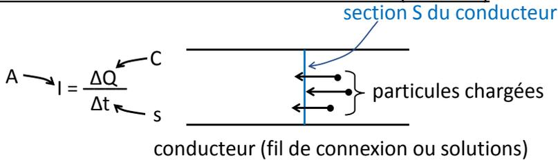
$\Delta Q$  : variation de charges ( $Q_{\text{final}} - Q_{\text{initial}}$ ) créée par le passage de particules chargées à travers la section  $S$ .
